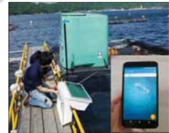
自動給餌機 (スマホで確認しながら遠隔給餌)
